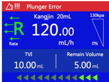
8-2 Alarme défaut piston
