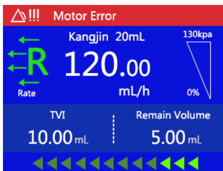
8-6 Alarme erreur moteur
